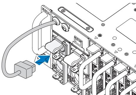
**注：**与 PSU 插槽连接的集成机箱交流电源电缆的正确配置如下图所示。
