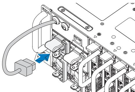
**メモ**：シャーシのインテグ럴 AC 電源ケーブルを PSU ソケットに接続した正しい構成は下図のとおりです。
