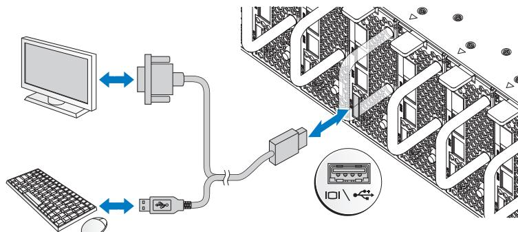
Konektor pada bagian depan sistem Anda memiliki ikon yang menunjukkan kabel mana yang harus dipasang. Hubungkan keyboard, mouse, dan monitor (opsional).
