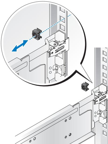
4 手順 1～4 を繰り返して、前面のエンドピースを垂直フランジに取り付けます。
