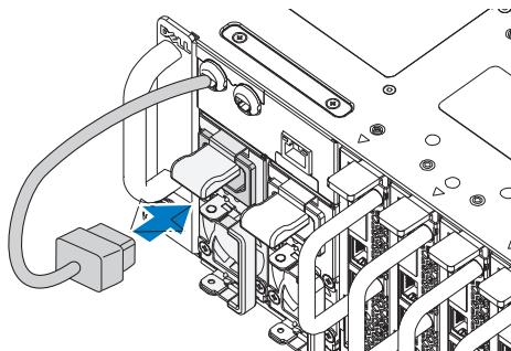
**CATATAN:** Konfigurasi yang benar dari kabel daya AC casis integral ke soket unit pencatu daya (PSU) diperlihatkan dalam ilustrasi berikut ini.
