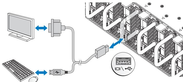
시스템 전면의 커넥터에는 각 커넥터에 연결될 케이블을 표시하는 아이콘이 있습니다. 키보드, 마우스 또는 모니터(선택 사양)를 연결합니다.
