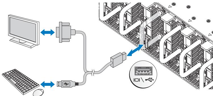
系统正面的连接器上有一个图标，指示要插入的电缆。连接键盘、鼠标或显示器（可选）。
