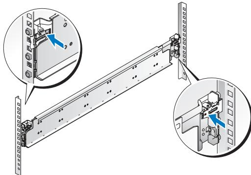
**2** 在机架垂直凸缘上对齐导轨的尾段，将插销放在第一个 U 的底孔中和第二个 U 的顶孔中。使导轨后端咬合，直到闩锁锁到位。
