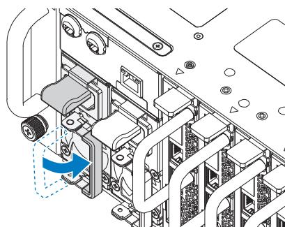
**3** シャーシの電源ケーブルを電源ユニットに接続します。
