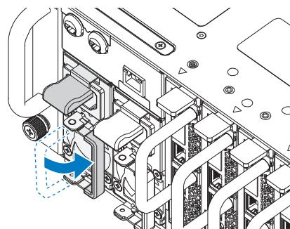
**3** 将机箱电源电缆插入电源设备。
